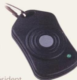
L'émetteur en pendentif permet également à un individu d'émettre une demande d'assistance depuis tout emplacement couvert par le système RoamAlert. Lorsqu'un individu presse le bouton en façade de l'émetteur, un message est envoyé au système et l'identité et la localisation de la personne sont affichées par le logiciel. À noter que cette application nécessite l'utilisation de récepteurs. Les émetteurs en pendentif sont garantis un an.
